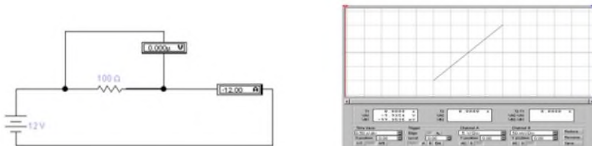
Сурет 2 Электр тізбегінің біртектімучаскесінің электрондық үлгісі
