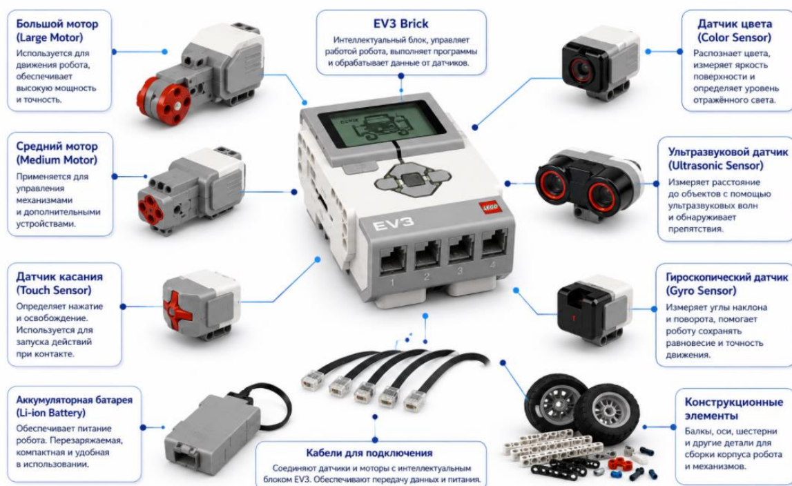
Рисунок 2.2 – Основные компоненты LEGO Mindstorms EV3
