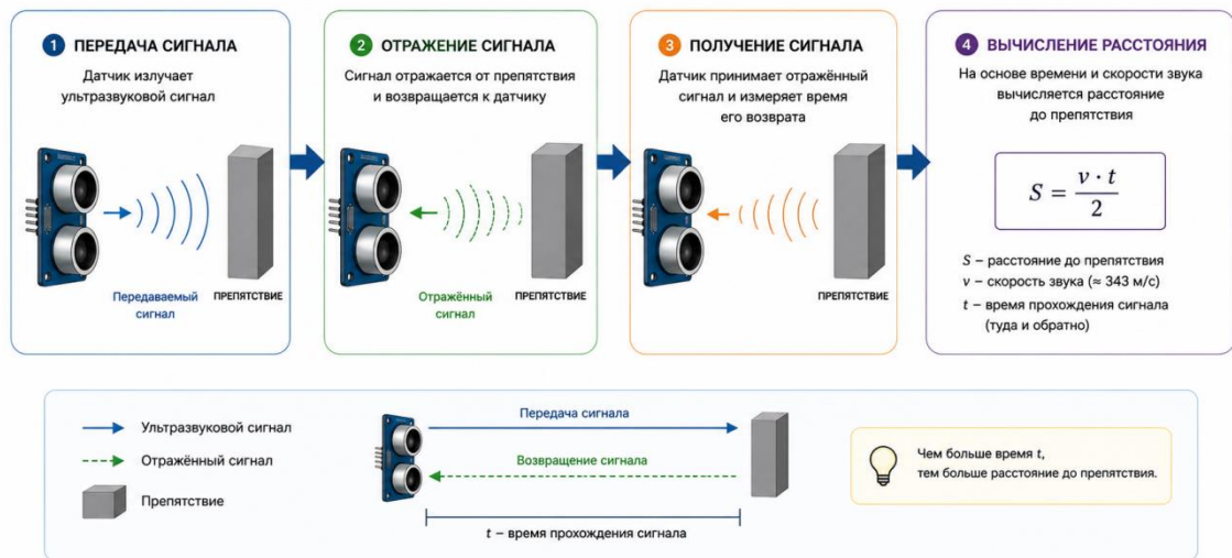
Рисунок 2.10 – Принцип работы ультразвукового датчика
