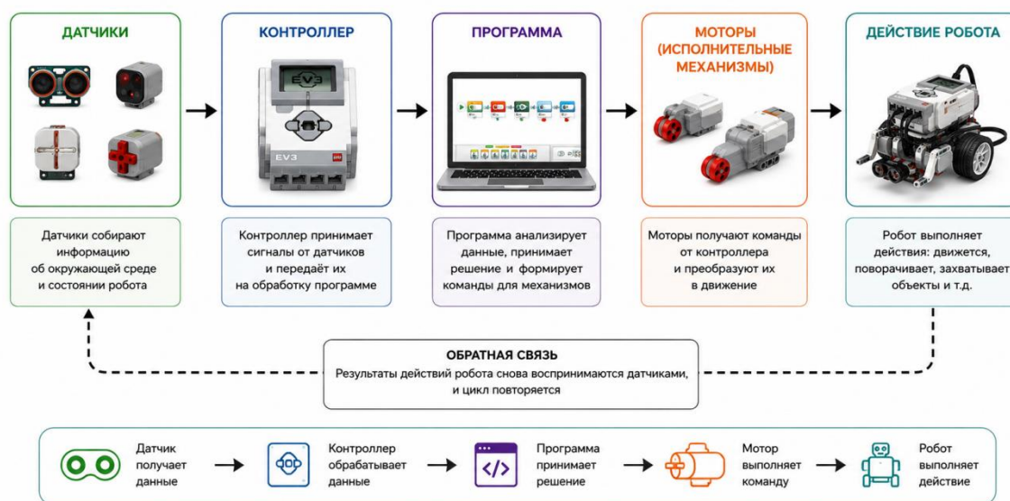
Рисунок 2.13 – Взаимодействие датчиков и исполнительных механизмов в робототехнической системе
