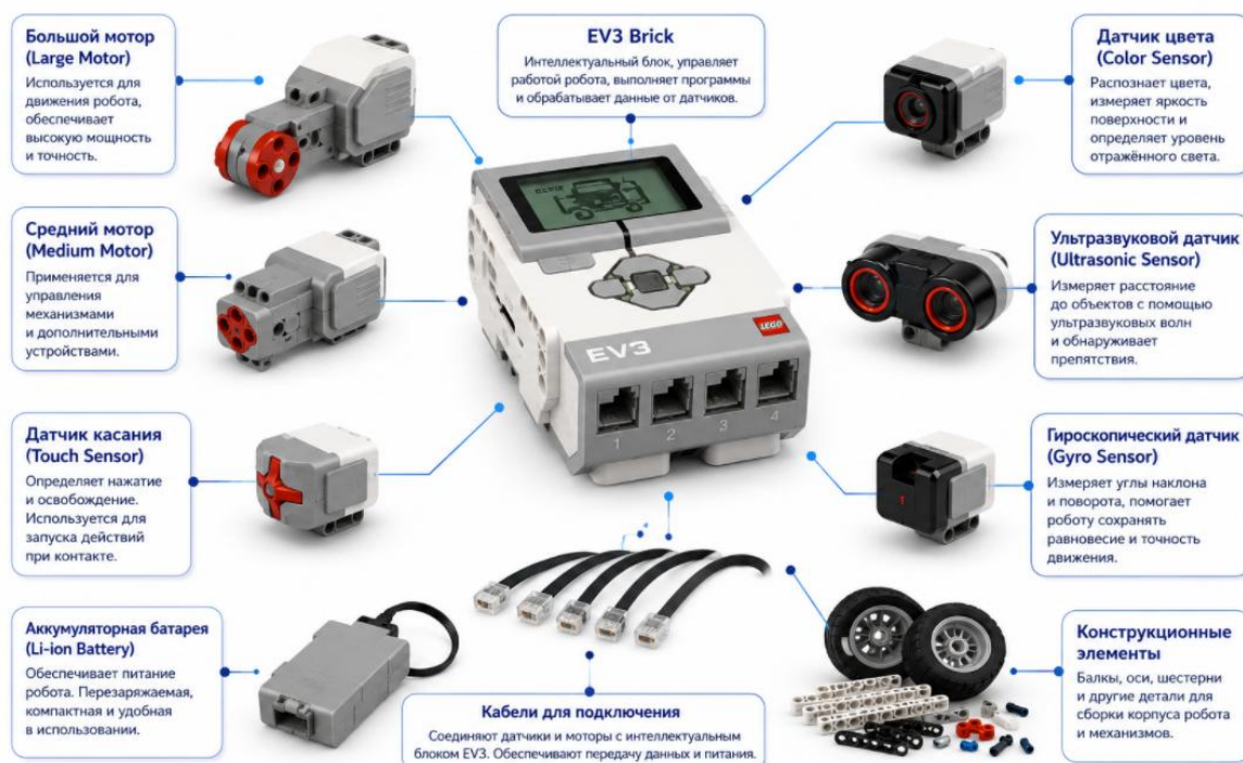
Рисунок 2.2 – Основные компоненты LEGO Mindstorms EV3
