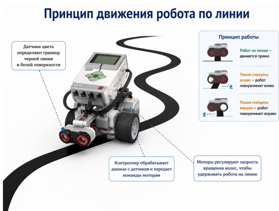
Рисунок 11.1 – Принцип движения робота по линии
