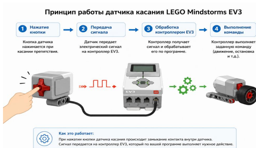
Рисунок 7.2 – Принцип работы датчика касания
