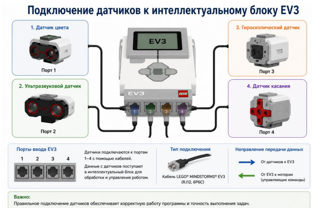
Рисунок 12.3 – Подключение датчиков к интеллектуальному блоку EV3
