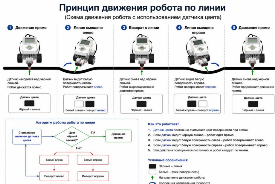
Рисунок 5.2 – Принцип движения робота по линии
