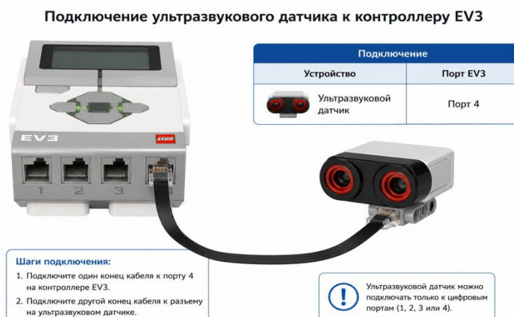
Рисунок 6.3 – Подключение ультразвукового датчика к контроллеру EV3
