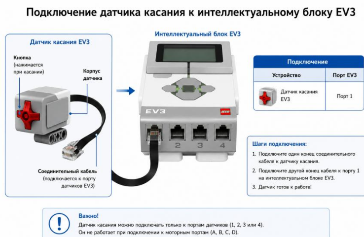
Рисунок 7.3 – Подключение датчика касания к интеллектуальному блоку EV3
