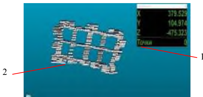
Рисунок 4 – Вид полученного облака точек 1 – координаты последнего касания; 2 – облако точек
