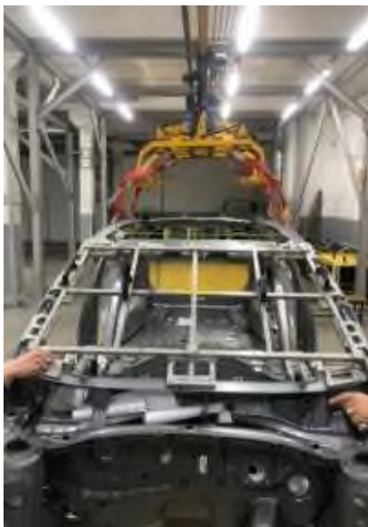
Рисунок 2 – Позиционирование замеряемого элемента по принципу лучшего совмещения
