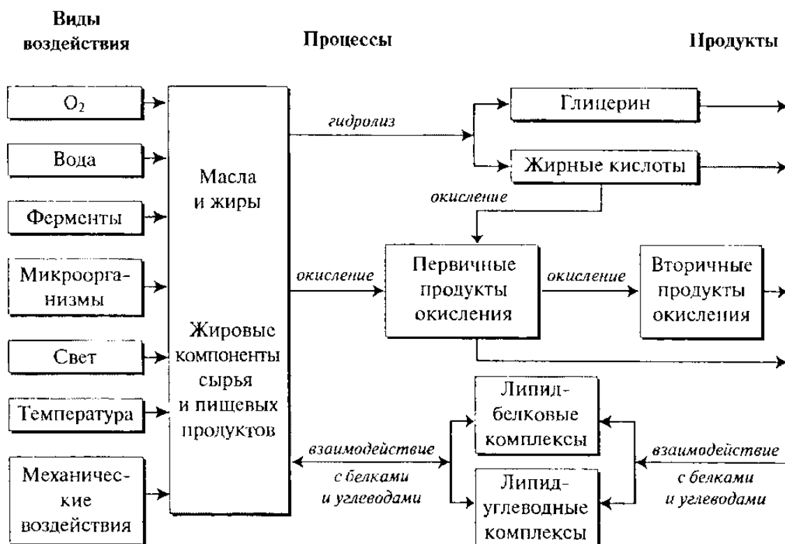
Рисунок 1. Превращения липидов в технологическом процессе (по Нечаеву, 2007)
